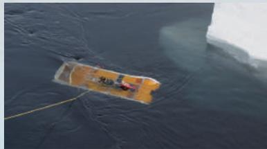
MONACA(水中ロボット)で氷の解けるスピードを調査。日本の観測隊では初めてAUV水中ロボットを導入。水中ロボットは、昭和基地周辺のラングホブデ氷河の氷の下を世界で初めて潜行・調査に成功しました。
